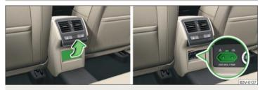
Fig. 108 Open the cover of the 230 volt outlet / 230 volt outlet
